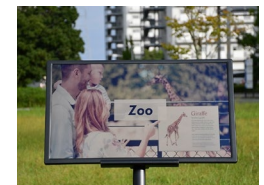
屋外での視認性が高い反射型IGZOディスプレイ
