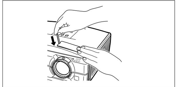
**2 Halten Sie das Objektiv zum Abnehmen mit einer Hand fest, damit es nicht herunterfällt, und schieben Sie die Objektivbefestigungsnase in Richtung "UNLOCK,,.**
