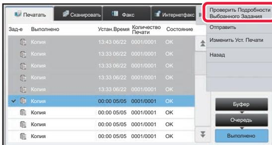
Коснитесь задания, параметры которого нужно проверить, затем на панели действий коснитесь пункта [Проверить Подробности Выбранного Задания].
