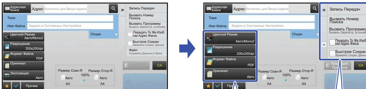
Кнопки настройки и панель действий увеличиваются. Настройки, которые больше не выводятся на панели действий, можно отобразить с помощью кнопок прокрутки. Настройки, которые больше не выводятся (в данном примере это кнопка [Экспозиция]), можно отобразить, нажав кнопку [Прочие].
