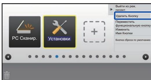
Коснитесь кнопки быстрого вызова, которую нужно удалить, затем коснитесь пункта [Удалить Кнопку].
