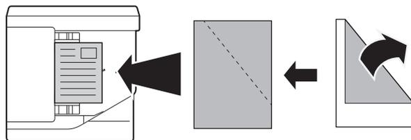
Si l'original est agrafé, assurez-vous de retirer les agrafes et de bien aérer les pages avant de le charger. (Ceci évite une mauvaise alimentation et le déchirement de l'original, ainsi que des morceaux déchirés de l'original de rester dans le chargeur.)
