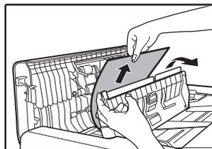
Poussez le levier de déverrouillage vers le haut et retirez l'original bloqué du plateau du chargeur de documents. Abaissez le levier de déverrouillage.
