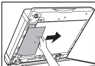
Ouvrez le chargeur de documents et faites tourner la molette de déverrouillage dans le sens de la flèche pour entraîner l'original.
