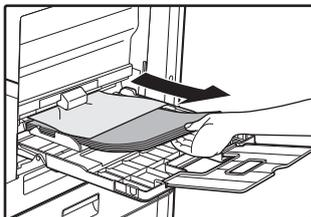
Retirez le papier encore présent dans le plateau d'alimentation auxiliaire.
