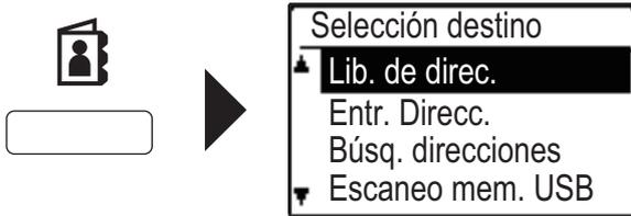
**Pulse la tecla [DIRECC.] (👤), seleccione "Lib. de direc." con la tecla [▼] y pulse la tecla [OK].**
