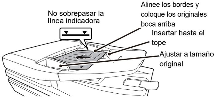
Si el original está doblado, alíselo antes de colocarlo. (Con ello se evita que se atasque el original y que se detecte incorrectamente el tamaño del original)
