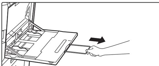
При загрузке бумаги, формат которой превышает A4R или 8-1/2" x 11"R, выдвигайте удлинитель. Выдвигайте удлинитель полностью.
