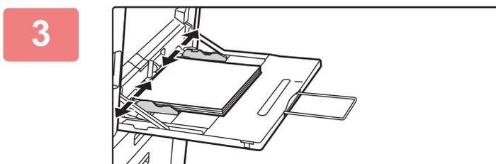
**Ajuste las guías de la bandeja bypass correctamente a la anchura del papel.**
