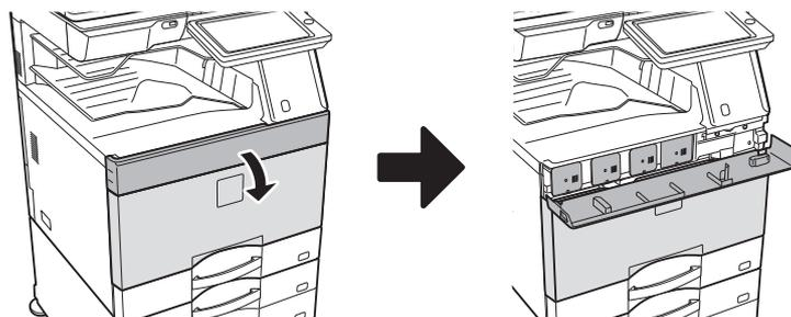
Öffnen Sie nicht versehentlich die untere Abdeckung. Dadurch wird der Druckvorgang unterbrochen und es kann zu einem Papierstau kommen.
