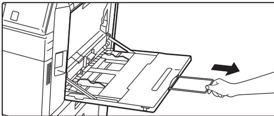
Ziehen Sie bei der Verwendung von Papier, das größer als A4R oder 8-1/2" x 11"R ist, die verlängerte Führung heraus. Ziehen Sie die Erweiterung vollständig heraus.
