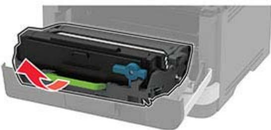
**Advarsel - Potentiel skade:** Billedenheden må ikke udsættes for direkte lys i mere end 10 minutter. Hvis produktet udsættes for lys i længere tid, kan det skabe problemer med udskriftskvaliteten.
