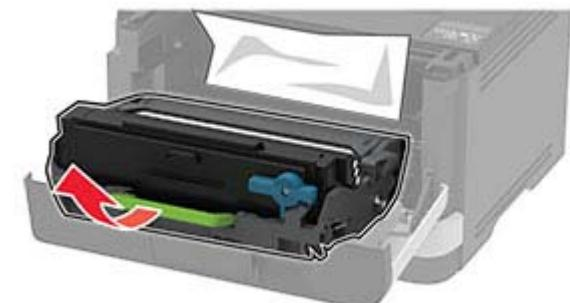
**Advarsel - Potentiel skade:** Billedenheden må ikke udsættes for direkte lys i mere end 10 minutter. Hvis produktet udsættes for lys i længere tid, kan det skabe problemer med udskriftskvaliteten.
