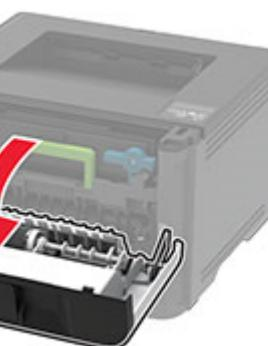
**Advarsel - Potentiel skade:** Billedenheden må ikke udsættes for direkte lys i mere end 10 minutter. Hvis produktet udsættes for lys i længere tid, kan det skabe problemer med udskriftskvaliteten.
