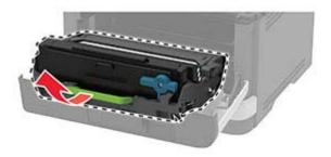
**3** Поверните синий фиксатор и извлеките картридж с тонером из использованного блока формирования изображения.
