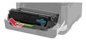
**3** Поверните синий фиксатор и извлеките использованный картридж с тонером из блока формирования изображения.
