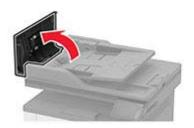
2 Снимите старую разделительную пластину УАПД.
