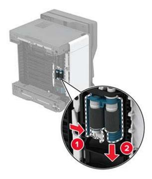
**9** Нанесите изопропиловый спирт на мягкую безворсовую ткань, а затем протрите узел валика захвата.
