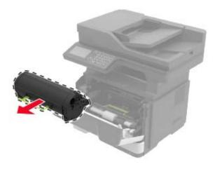
**3** Nehmen Sie die neue Tonerkassette aus der Verpackung, und schütteln Sie sie drei Mal, um den Toner zu verteilen.
