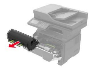
4 Entfernen Sie die Belichtungseinheit.
