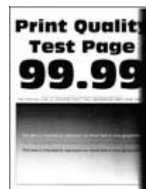
Vertikale mørke striper på side 184
