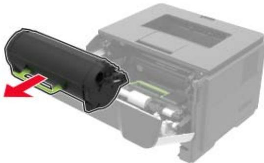
4 Entfernen Sie die Belichtungseinheit.
