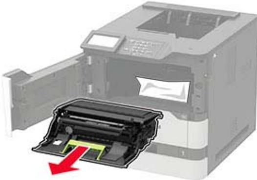
**Advarsel - Potentiel skade:** Billedenheden må ikke udsættes for direkte lys i mere end 10 minutter. Hvis produktet udsættes for lys i længere tid, kan det skabe problemer med udskriftskvaliteten.
