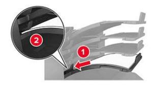
**Remarque :** Un bourrage se produit en raison d'une surcharge du réceptacle si le papier n'est pas placé sous le bras du réceptacle.
