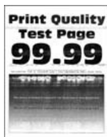
„Vodorovné světlé pásy“ na straně 156
