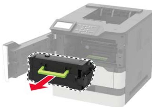
**3** Распакуйте новый тонер-картридж, затем потрясите его, чтобы распределить внутри тонер.
