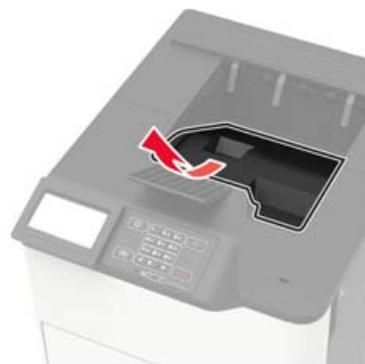
3 Извлеките использованный очиститель валика для термического закрепления.
