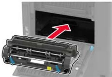
**8** Закрепите валик для термического закрепления.
