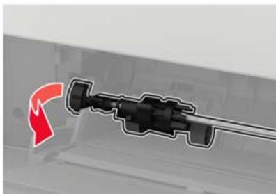
**4** Нанесите изопропиловый спирт на мягкую безворсовую ткань, а затем протрите ролик захвата.
