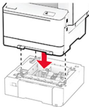
**Nota:** Per evitare una configurazione non valida, quando si installano sia il vassoio da 550 fogli che il vassoio da 650 fogli, posizionare sempre il vassoio da 550 fogli sotto il vassoio da 650 fogli.
