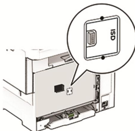
**6** Inserire l'unità di archiviazione nel connettore dell'unità ISD.
