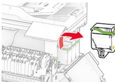
**6** Rimuovere il kit di imaging.
