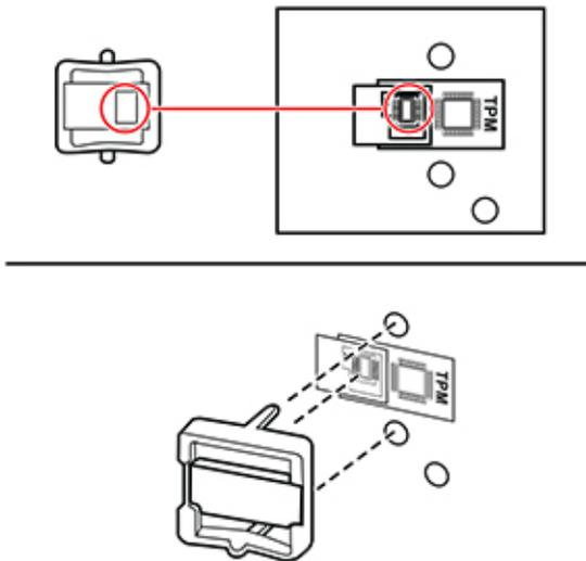
7 Fissare la schermatura della scheda del controller, quindi installare le viti.
