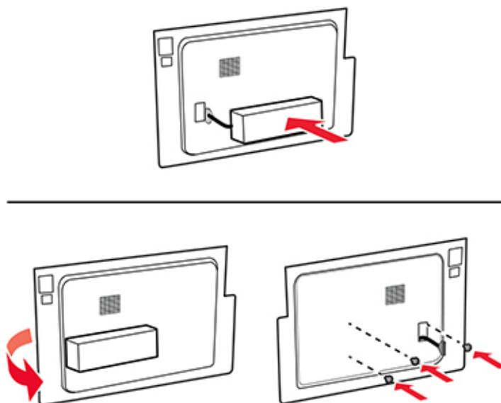
**8** Collegare il cavo di interfaccia del disco fisso alla scheda del controller.
