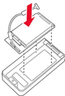
**7** Inserire il disco fisso sulla schermatura della scheda del controller.
