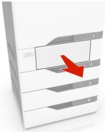
**Attenzione - Possibili danni:** un sensore all'interno del vassoio opzionale viene facilmente danneggiato dall'elettricità statica. Prima di rimuovere la carta inceppata nel vassoio, toccare una superficie metallica.
