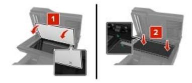
**5** Chiudere il coperchio dello scanner per fare aderire il tampone di acquisizione dell'ADF al coperchio.
