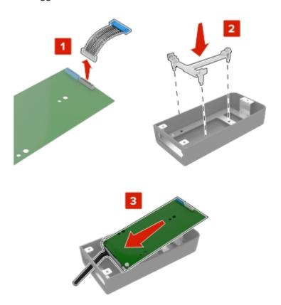
Fissare l'alloggiamento al coperchio di accesso alla scheda del controller.
