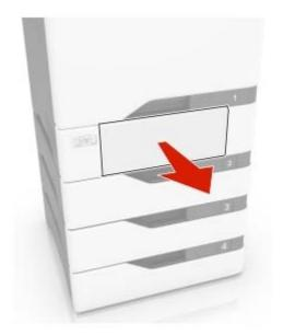
**Attenzione - Possibili danni:** un sensore all'interno del vassoio opzionale viene facilmente danneggiato dall'elettricità statica. Prima di rimuovere la carta inceppata nel vassoio, toccare una superficie metallica.
