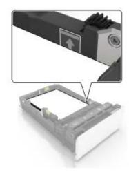
Inserire il vassoio.Se necessario, impostare il formato e il tipo di carta in base alla carta caricata nel vassoio.
