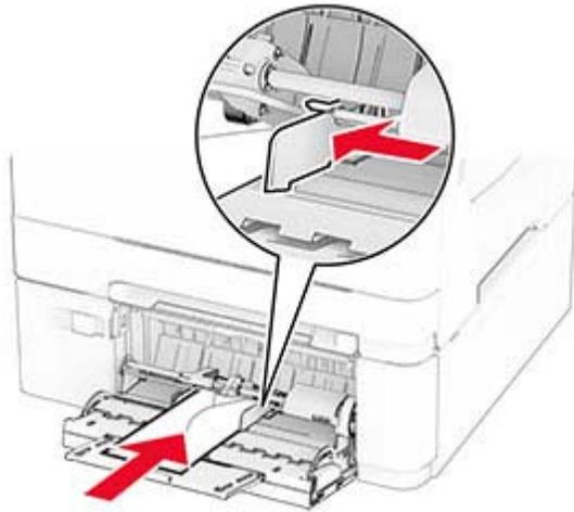
**Warnung—Mögliche Schäden:** Es dürfen keine Umschläge mit Briefmarken, Metallklammern, Haken, Fenstern, Fütterung oder selbstklebenden Klebeflächen verwendet werden.
