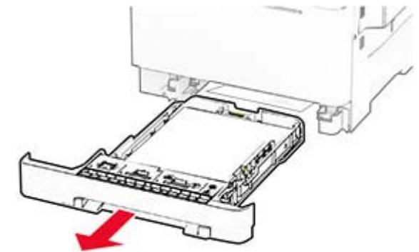
**Advertencia: Posibles daños:** Un sensor dentro de la bandeja opcional se daña fácilmente con la electricidad estática. Toque una superficie metálica antes de retirar el papel atascado en la bandeja.
