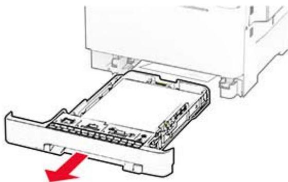
**Предупреждение – Риск повреждения!** Датчик внутри дополнительного лотка может выйти из строя под действием статического электричества. Перед тем как прикоснуться к замятой бумаге в лотке, дотроньтесь рукой до какой-нибудь металлической детали принтера.
