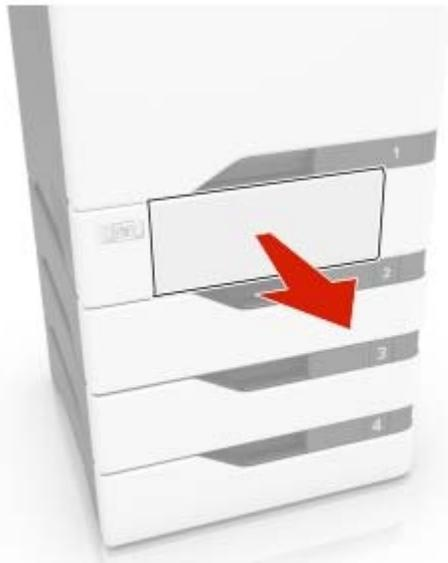
**Waarschuwing: mogelijke beschadiging:** Een sensor in de optionele lade kan gemakkelijk beschadigd raken door statische elektriciteit. Raak een metalen oppervlak aan voordat u het vastgelopen papier uit de lade verwijderd.
