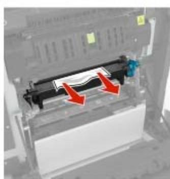
3 Open de toegangsklep van het verhittingsstation.
