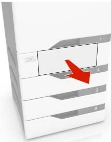
**Предупреждение – Риск повреждения!** Датчик внутри дополнительного лотка может выйти из строя под действием статического электричества. Перед тем, как прикоснуться к замятой бумаге в лотке, дотроньтесь рукой до какой-нибудь металлической детали принтера.
