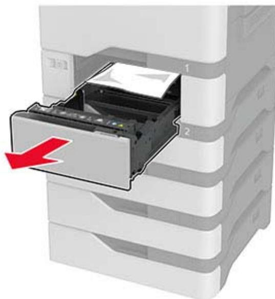
**Attenzione - Possibili danni:** un sensore all'interno del vassoio opzionale viene facilmente danneggiato dall'elettricità statica. Prima di rimuovere la carta inceppata nel vassoio, toccare una superficie metallica.
