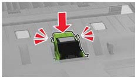
**6** Inserte el rodillo de carga del ADF hasta que *encaje* en su sitio.
