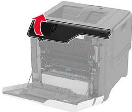
4 Öffnen Sie die Zugriffsklappe der Fixierstation.
