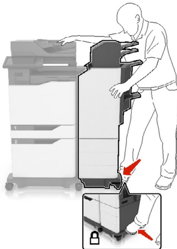
Assurez-vous que l'unité de finition et l'imprimante sont correctement enclenchées en tirant fermement sur l'unité de finition. Si l'unité de finition se détache de l'imprimante, répétez les étapes [étape 13](#) à [étape 14](#) jusqu'à ce qu'elle s'enclenche correctement.
