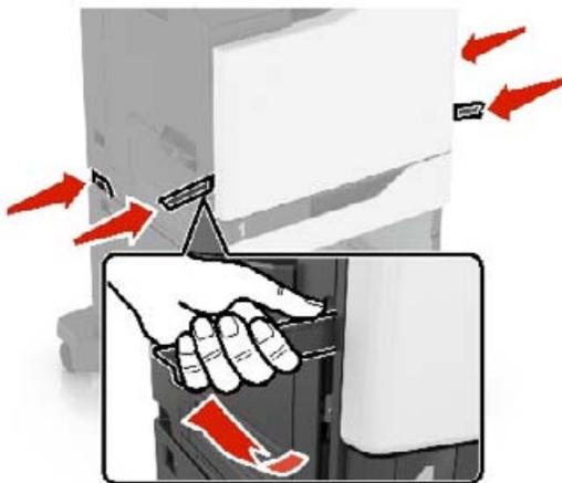
**Remarque** : Si des tiroirs optionnels sont déjà installés, déverrouillez-les sur l'imprimante avant de la soulever. N'essayez pas de soulever l'imprimante et les tiroirs en même temps.
