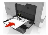
• Legen Sie Briefumschläge so ein, dass die Umschlagklappe nach oben und zur linken Seite der Papierführung zeigt. Legen Sie europäische Briefumschläge mit dem Umschlagklappenbereich voran ein.
