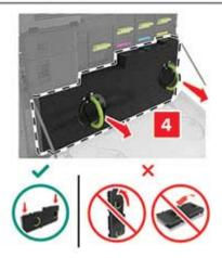
**3** Entfernen Sie die Belichtungseinheit.
