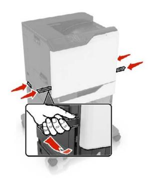
**Hinweis:** Wenn optionale Fächer bereits installiert sind, dann entsperren Sie sie vom Drucker, bevor Sie diesen anheben. Versuchen Sie nicht, den Drucker und die Fächer gleichzeitig anzuheben.
