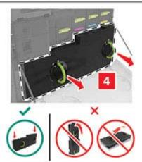
**3** Entfernen Sie die Belichtungseinheit.
