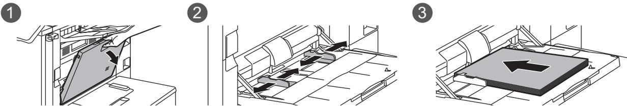
Coloque o papel com a face a imprimir voltada para baixo.
