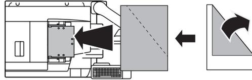
Se o original estiver agrafado, retire todos os agrafos e folheie bem as páginas antes de o colocar. (Isto destina-se a evitar que o original fique encravado ou se rasgue e impedir que os fragmentos rasgados do original fiquem no alimentador.)
