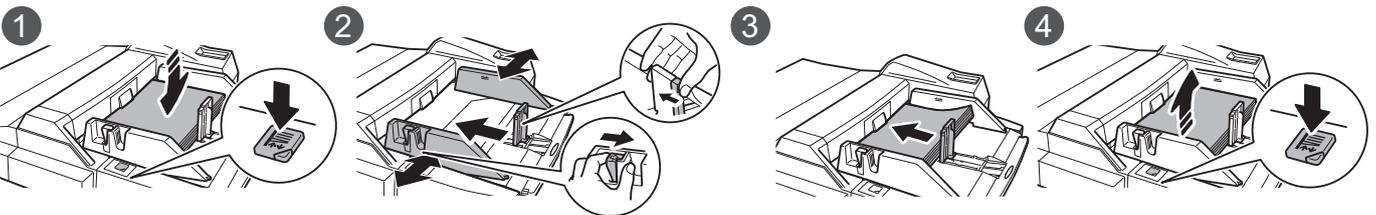
Coloque o papel com a face a imprimir voltada para baixo.
