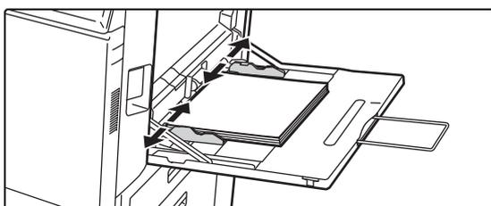
Régalez les guides du plateau d'alimentation auxiliaire correctement en fonction de la largeur du papier.
